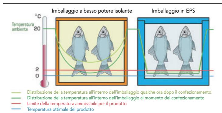
**Confronto tra le evoluzioni di temperatura** di un imballo dotato di debole potere isolante ed un packaging in EPS. Il polistirolo ha caratteristiche di isolamento termico nettamente superiori rispetto ad altri materiali.
